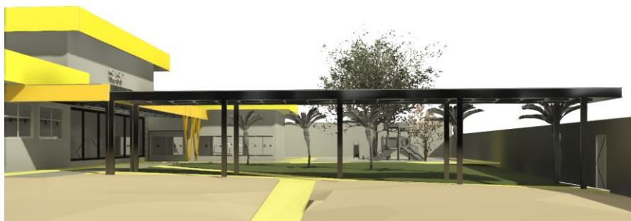
Figura 12 – PASSARELA 05 (PASSARELA ENTRADA ITEM 5 DA PLANILHA) - de acesso a Unidade Escolar – em estrutura metálica com telha metálica, acabamento preto fosco.
